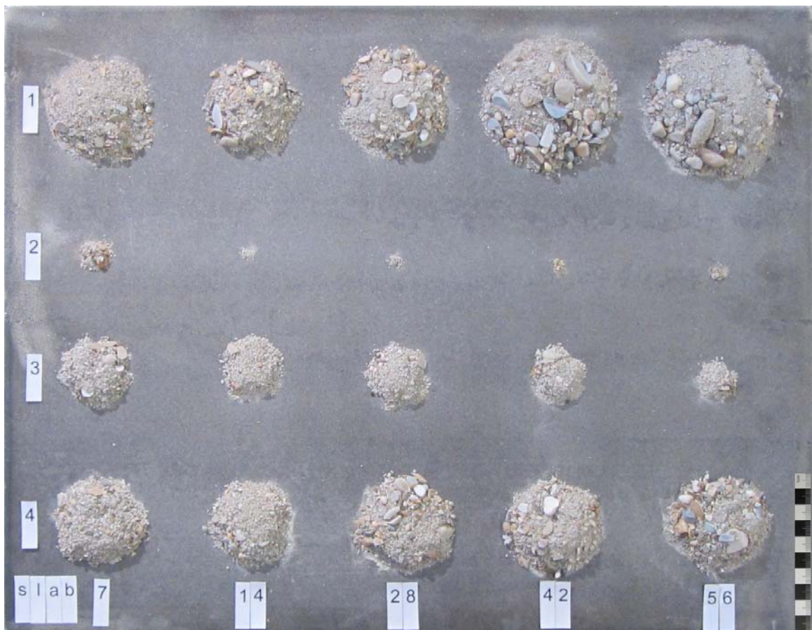
Bild 34: Zusammenstellung der bei der Plattenprüfung in den Papierfiltern aufgefangenen Abwitterungsmengen jeweils eines Probekörpers der vier Betonserien (1 bis 4) in Abhängigkeit von der Anzahl an Frost-Tau-Wechseln (7, 14, 28, 42 und 56)
