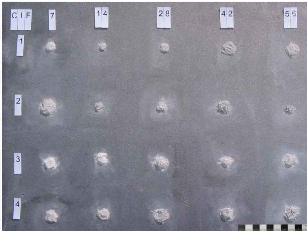
Bild 32: Zusammenstellung der bei der CIF-Prüfung in den Papierfiltern aufgefangenen Abwitterungsmengen jeweils eines Probekörpers der vier Betonserien (1 bis 4) in Abhängigkeit von der Anzahl an Frost-Tau-Wechselln (7, 14, 28, 42 und 56)
