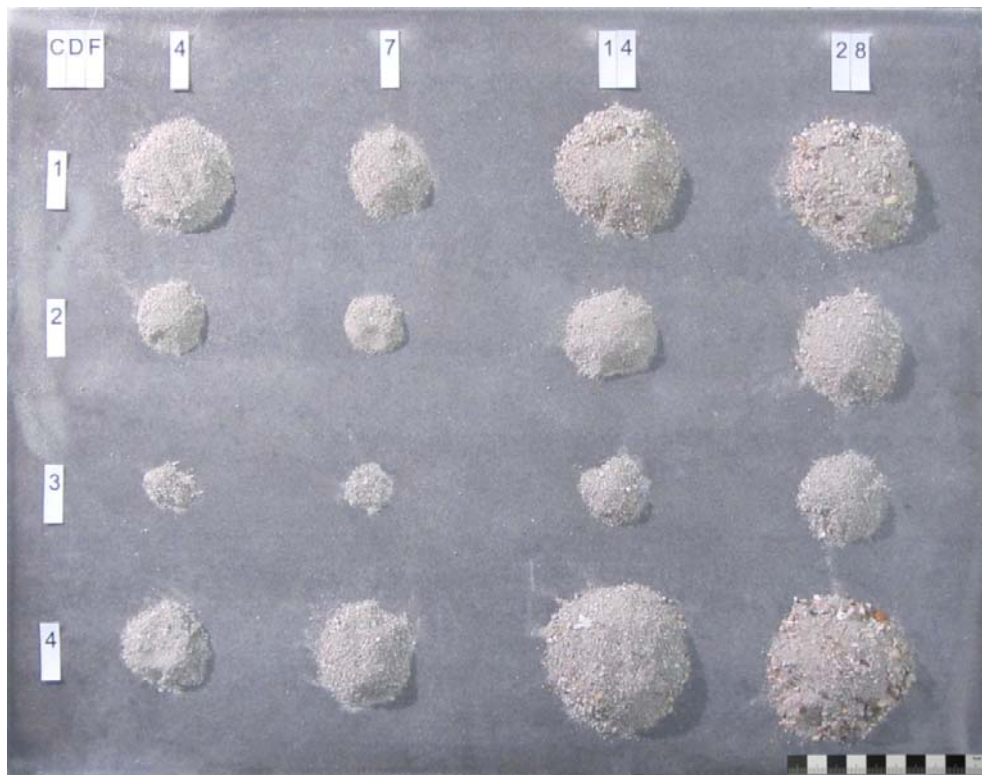
Bild 33: Zusammenstellung der bei der CDF-Prüfung in den Papierfiltern aufgefangenen Abwitterungsmengen jeweils eines Probekörpers der vier Betonserien (1 bis 4) in Abhängigkeit von der Anzahl an Frost-Tau-Wechseln (4, 7, 14 und 28)
