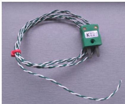
Abbildung 10: Thermoelement Typ K
