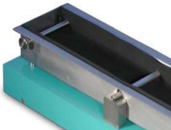
Abbildung 4: Die beiden Widerlager bei der Schüsselrinne
