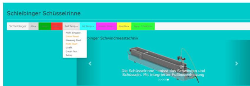
Abbildung 18: Menüauswahl für die Temperaturprofileingabe für die Schüsselrinne.
